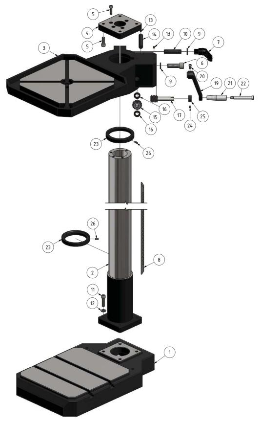
7-11: Bohrtisch - Drilling table - DH 28 GSV
